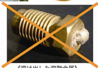
溶栓（容器安全弁）にふくらみが見られる場合は、容器の使用（回収作業・移動・貯蔵）、容器温度・内部圧力の上昇により突発的に溶栓が作動し、回収フロンの全量大気放出、溶融金属の飛び出しなどの事故・災害に至る危険があります。速やかに、容器検査所\*にて、溶栓の交換、再検査を受けて下さい。
